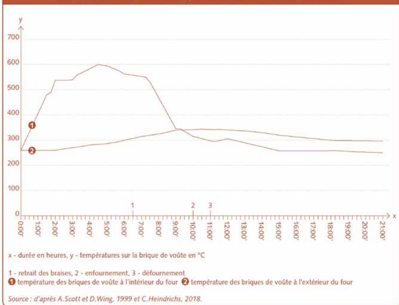
FIG. 31. PRISE DE TEMPÉRATURE DES BRIQUES DE VOÛTE DANS LA CHAMBRE DE CUISSON
